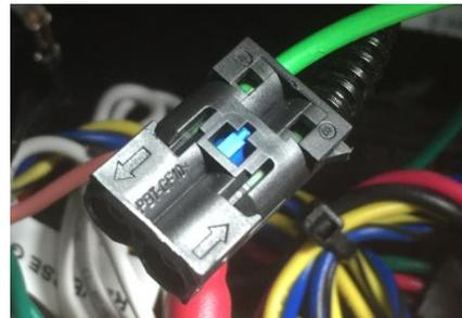
Dann drücken sie den mittleren Clip vom Gehäuse und entfernen sie den Lichtleiter der mit Signaleingang gekennzeichnet ist.
