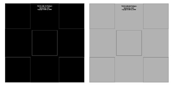
Fig. 4.4 TG18-UNL10 an TG18-UNL80 test pattern
