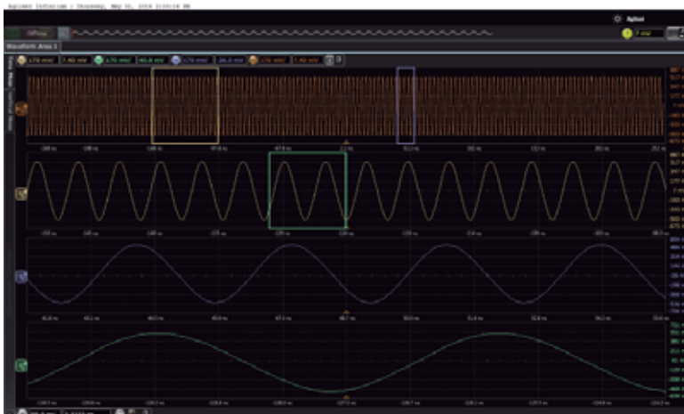
Figura 7. Las ventanas de medida permiten a los usuarios estudiar al mismo tiempo varias instancias de una forma de onda.
