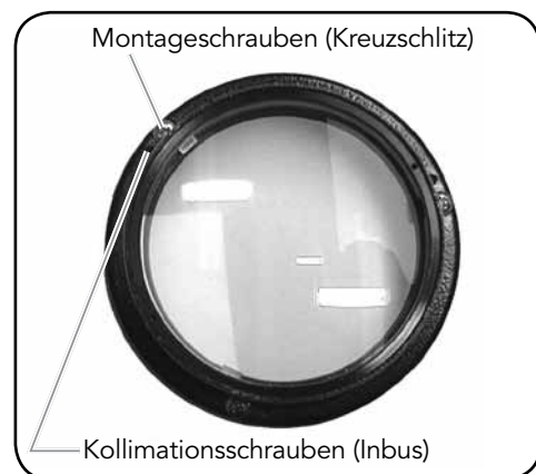
OBJEKTIVLINSENGEHÄUSE (GEGENLICHTBLENDE ENTFERNT) MIT MONTAGE- UND KOLLIMATIONSSCHRAUBEN
