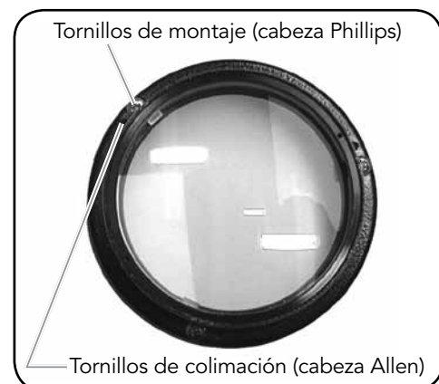
EL PORTAOBJETIVO (CON LA VISERA QUITADA) MUESTRA LOS TORNILLOS DE MONTAJE Y COLIMACIÓN.
