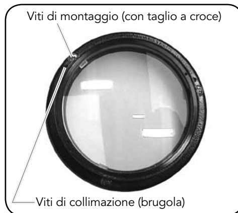
ALLOGGIAMENTO DELLALENTE DELL'OBBIETTIVO (CON COPRI-OBIETTIVO RIMOSSO); MOSTRATI LA MONTATURA E LE VITI DI COLLIMAZIONE.
