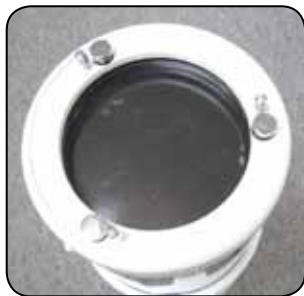
MIROIR PRIMAIRE. LES GROSSES VIS MOLETÉES SONT POUR LA COLLIMATION ET LES PETITES POUR MAINTENIR LE MIROIR EN POSITION.
