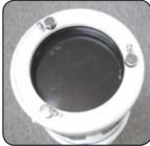
SPECCHIO PRIMARIO. LE VITI ZIGRINATE GRANDI SONO PER LA COLLIMAZIONE, MENTRE QUELLE PICCOLE SONO PER BLOCCARE LO SPECCHIO IN POSIZIONE.
